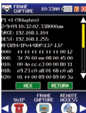
Erfasst bis zu 10.000 Pakete für die Auswertung, einschließlich Paketgröße, Quell- und Ziel-IP-Adresse, Zeitstempel und Pakettyp. Benutzerdefinierte Filter erfassen spezifische, für die Erkennung von Problemen benötigte Daten und überwachen die Performance.
