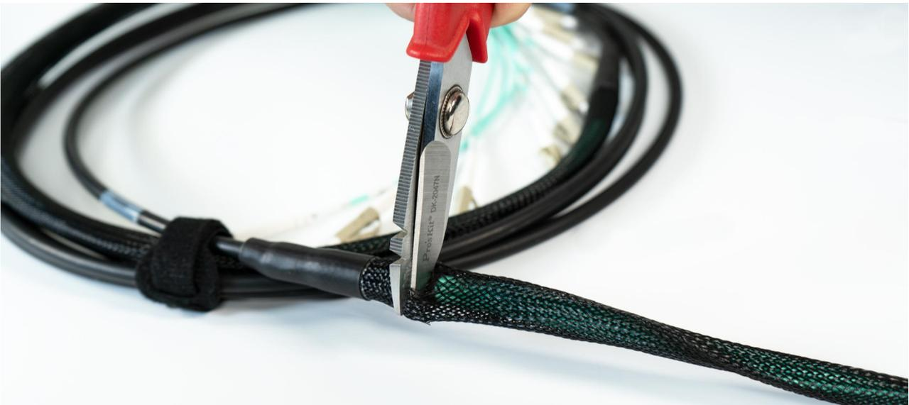
1. Einschneiden der Geflechts-Einzughilfe direkt hinter dem Kabelaufteiler
