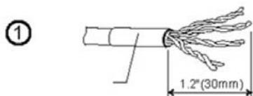
Kabel ca. 30 mm abisolieren, Geflechschirm nach hinten legen. Aluminiumfolie der Paarschirmung entfernen. Mitgelieferte Kupferfolie außen über dem Geflechschirm mit der Klebeseite nach innen anbringen.
