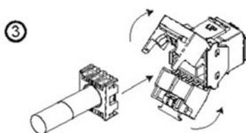
Abschlusskappe in das Gehäuse einsetzen. Die Adern werden dabei in die entsprechenden Schlitze geführt.
