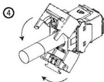
Den klappbaren Teil des Gehäuses mit einer geeigneten Zange (z.B. Rohrzanze) zusammenpressen bis er deutlich und vollständig einrastet.
