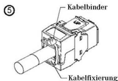
Kabelfixierung mittels Kabelbinder sichern.
