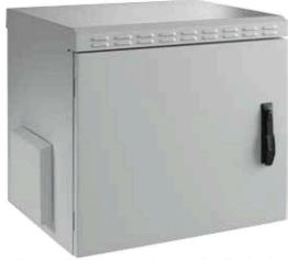
Die links- und rechtsseitigen Lufteinlässe mit Filtern (IP54) sind zusätzlich durch äußere Metallhauben geschützt. Dies ermöglicht die Frischluftzufuhr sowie Evakuierung der Abluft durch die Lamellen im Dach.
